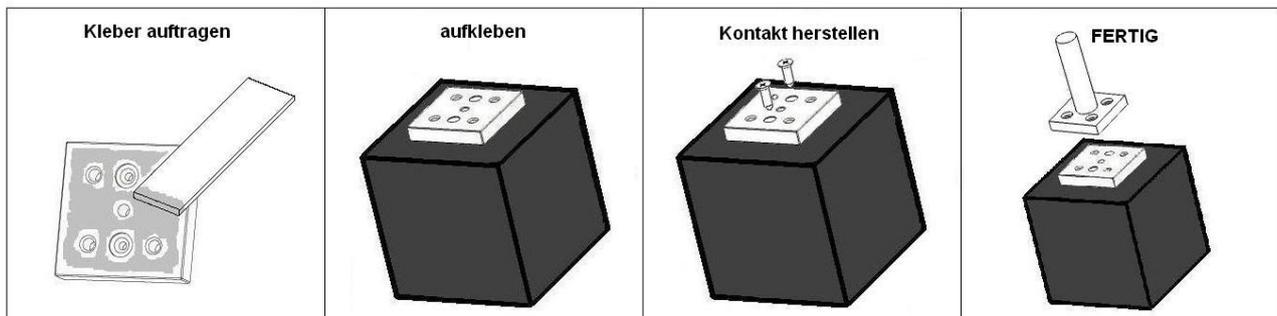
Als Kleber kann ein handelsüblicher Zweikomponenten-Schnellkleber, der für Metall- und Graphitwerkstoffe geeignet ist, verwendet werden. Kleber ist nicht im Lieferumfang enthalten.
